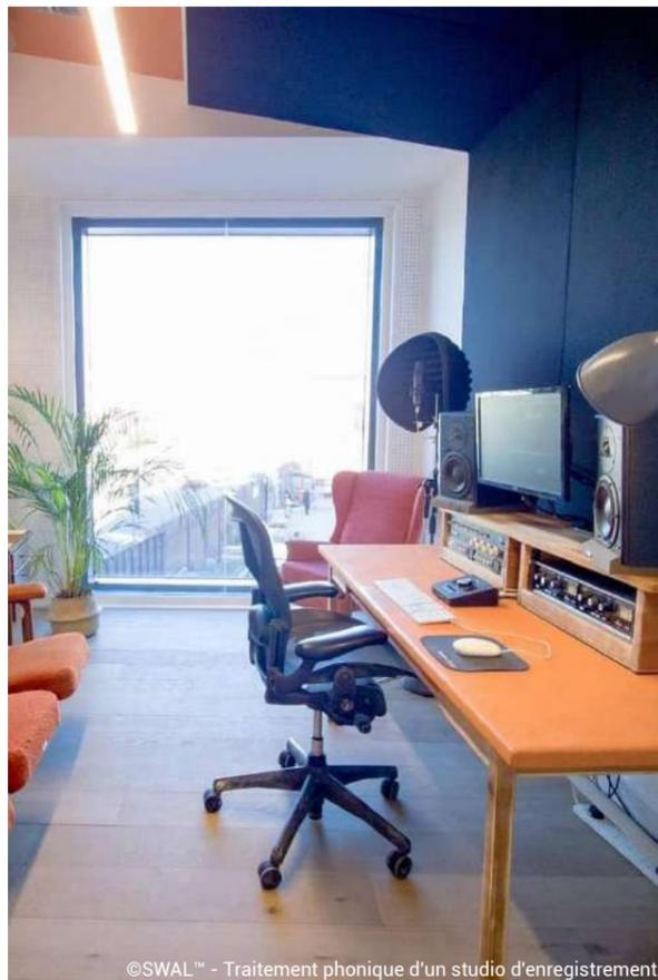
Le système SWAL™ agit comme un piège à sons, en combinant une toile microperforée et un absorbant placé à l'arrière. La toile laisse passer les ondes sonores plus ou moins longues, qui sont ensuite absorbées et dissipées par le matériau.
